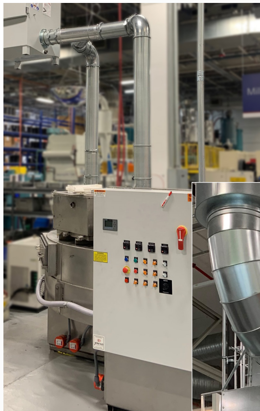
QFS Ducto instalado en maquinas en instalaciones de fabricación de piezas automotrices
